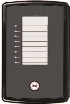
L'annonceur à distance avec une sirène intégrée est un module d'extension de sortie LED conçu pour afficher un maximum de huit indications LED individuelles jusqu'à une distance maximale de 1 km (0,6 miles). L'annonceur se composera de deux modules pour fournir une annonce de défaut à 16 canaux. Les panneaux sont équipés de cartes d'étiquettes amovibles qui peuvent être utilisées pour identifier les alarmes standard NFPA.
